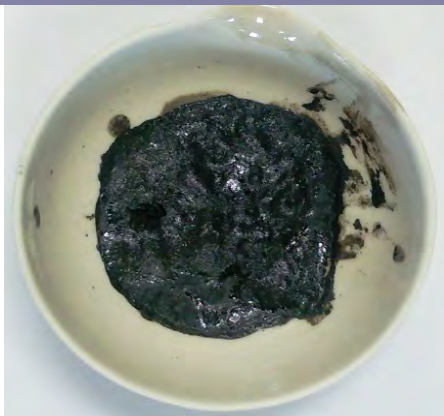
コークス炉ガス配管内の 付着物例
