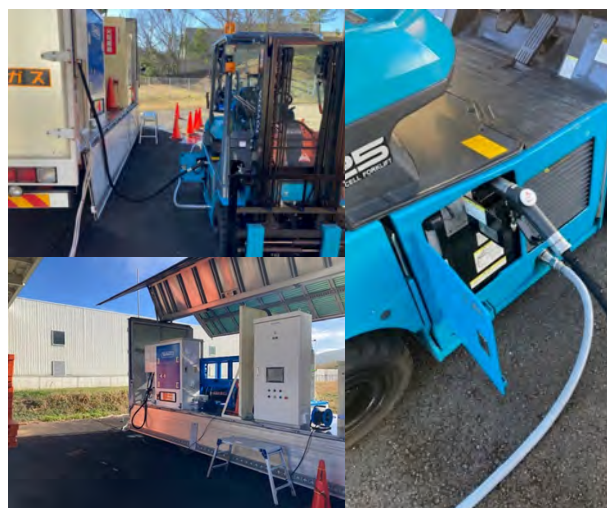
燃料電池式のフォークリフトの実証実験 水素活用の推進に貢献
