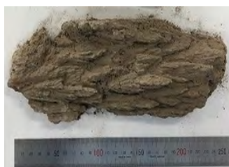
実機炉内クリンカ
